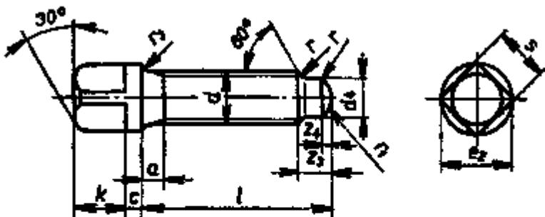
Označení upínacího šroubu s nákružkem a s čípkem<sup>1)</sup>, se závitem M10, s délkou  $l = 50$  mm, s mechanickými vlastnostmi 5D<sup>2)</sup> a s čistým povrchem<sup>3)</sup>:
