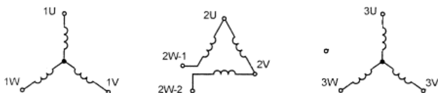
Obrázek A.17 - Příklad motoru pro troje otáčky s konstantním momentem a dvěma oddělenými vinutími, deset svorek
