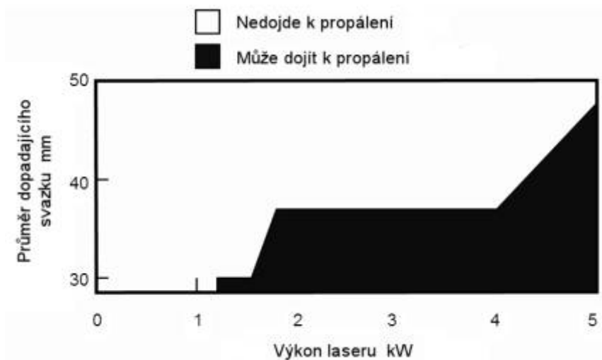
Obrázek F.9 - Odolnost proti poškození krytu z nerezového ocelového plechu o tloušťce 1 mm vystaveného rozostřenému svazku CO 2 laseru s kontinuálním vyzařováním po dobu 10 s
